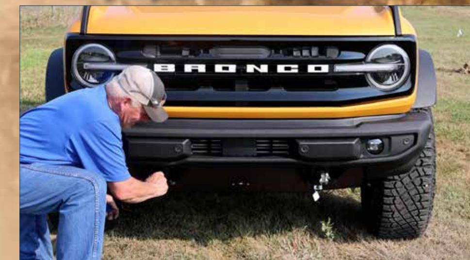
Pour installer les languettes, les tourner et les verrouiller.
